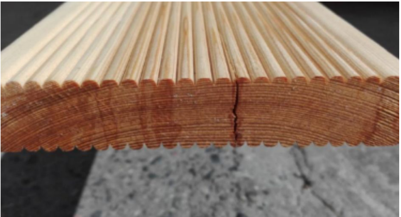
Foto 6 – ein frontal gelegener, durchlaufender Riss
